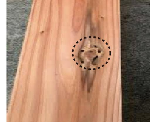
枝虫材とは「スギノアカネトラカミキリ」という昆虫による食害を受けた木材のこと。原因として林業従事者の減少により枝打ちのされない木が増えていることが挙がる。ただ建材としては構造的に問題はなく、虫が後から出てくることもない。
