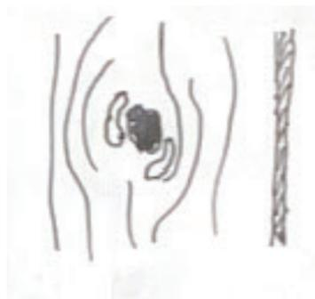
枝虫材は、杉、桧の枝打ちがされていない木にスギノアカネトラカミキリが卵を産み虫食い跡が残った材である。年々、強度や腐朽については問題ないことが実験により証明されている。しかし、見た目の悪さから嫌われ、見えない部分での使用もしくは燃料用チップとして活用されている現状である。
